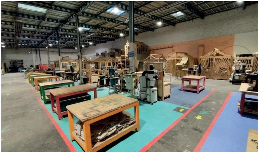
Espace de 1000 m<sup>2</sup> géré par un chef d'atelier. Machines pour fabrication bois, métal et plastique. Principales Machines disponibles dans la halle C : scie à découpe verticale ; Perceuses à colonne de Table ; Touret à Meuler ; Scies circulaire Sur table ; Scie à onglet radiale ; Scie Plongante Makita ; combiné Raboteuse Dégauchisseuse ; Scie à chantourner ; Défonceuse ; Ponceuse ; meuleuses ; poste à souder à l'arc, etc...
